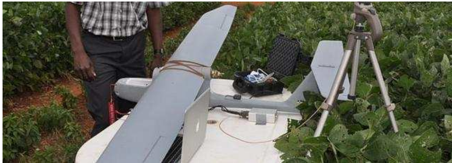
'Skywalker' porta una cámara multispectral y una cámara térmica. UB
