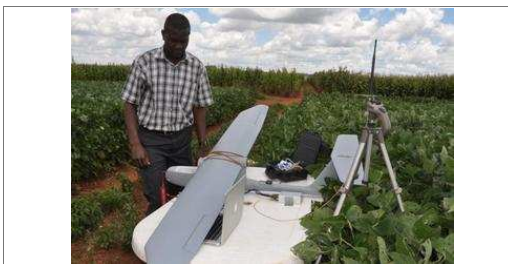
Skywalker es una sofisticada plataforma de fenotipaje aéreo constituida por un avión teledirigido dotado de un avanzado sistema de vuelo. / UB
