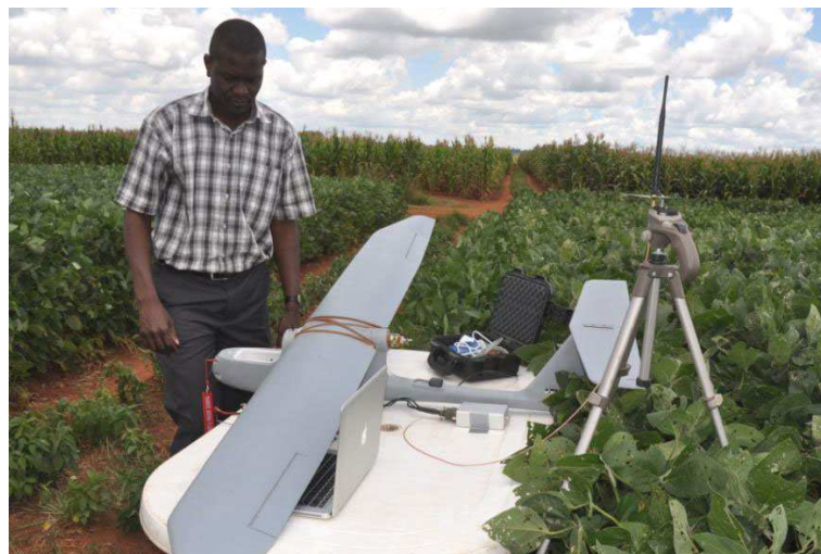
El Skywalker es una sofisticada plataforma de fenotipaje aéreo constituida por un avión teledirigido dotado de un avanzado sistema de vuelo.
