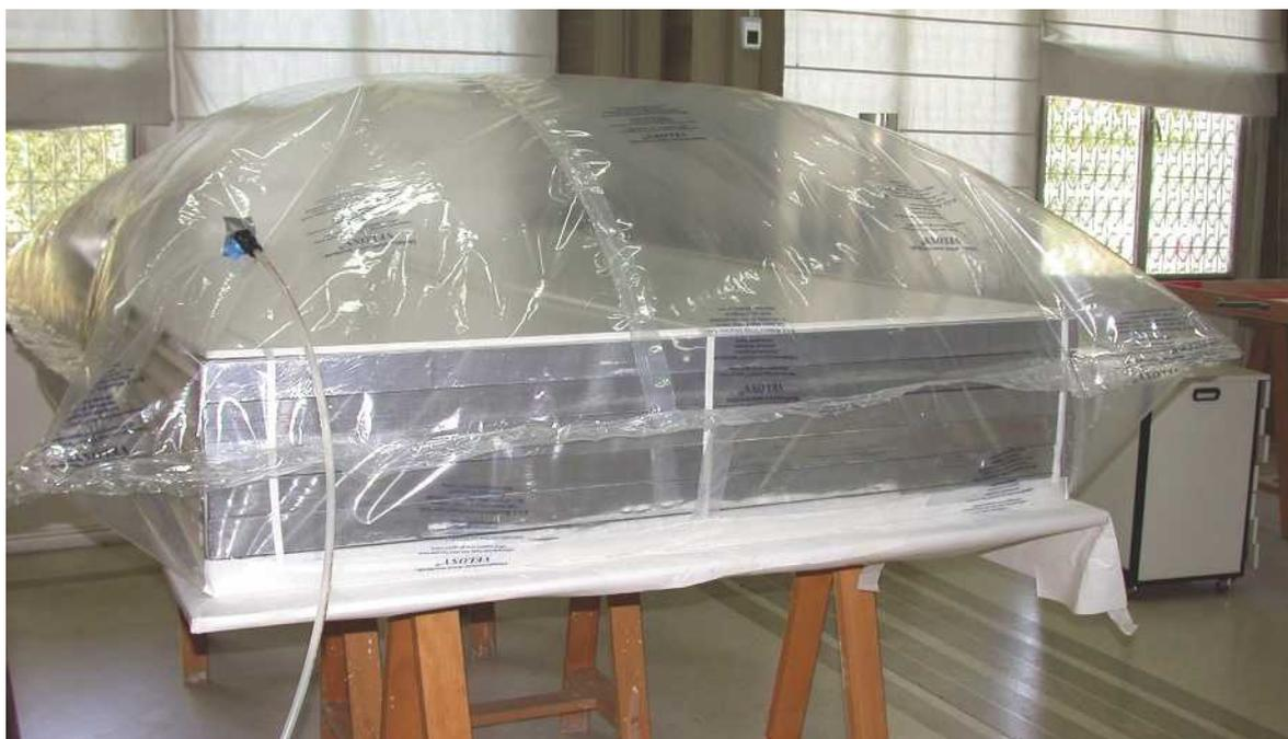
Mediante la anoxia, un tratamiento por el que se elimina el oxígeno, con generadores de nitrógeno, se consigue el 100% de mortalidad de los insectos.
