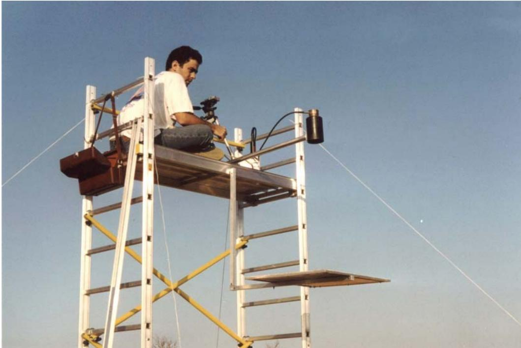
**Figura 3-4** Plataforma para la medida del factor de reflectancia.
