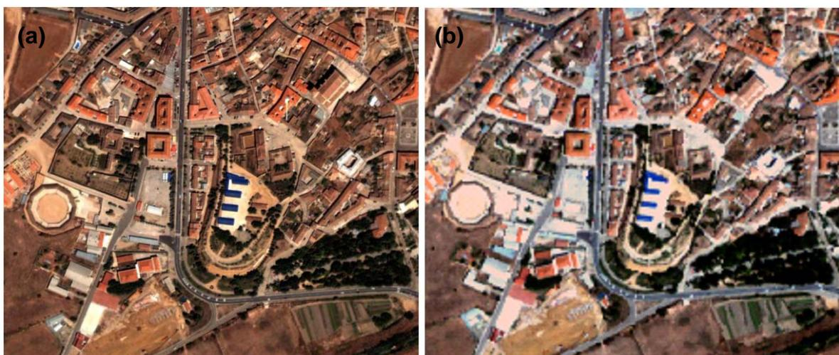
**Figura 4-2 Comparación entre una imagen fusionada (a) y una imagen multiespectral (b).**
